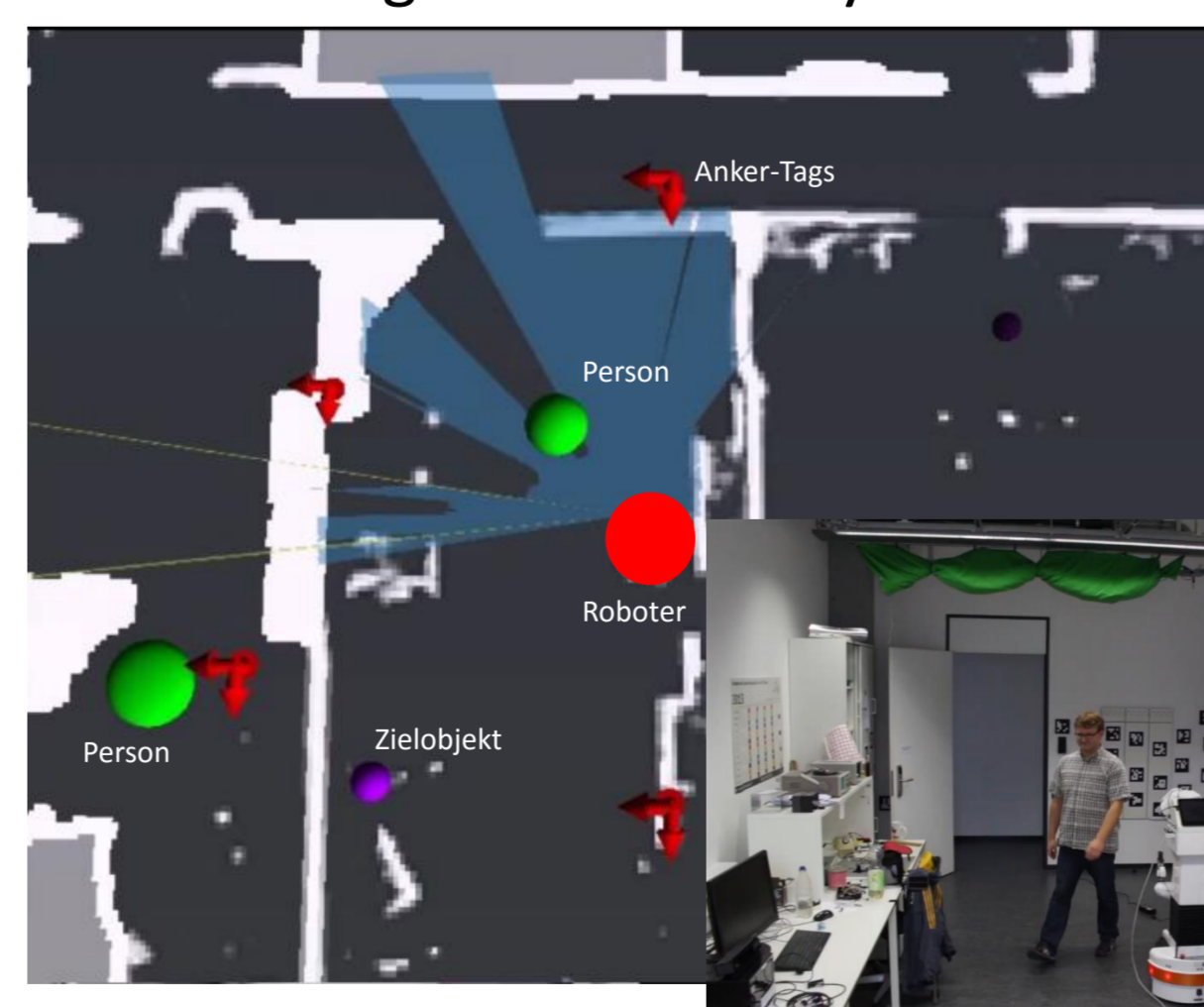
Lokalisierungsergebnis in der Laborumgebung mit Personen im Sichtbereich des Roboters und in den benachbarten Räumen
